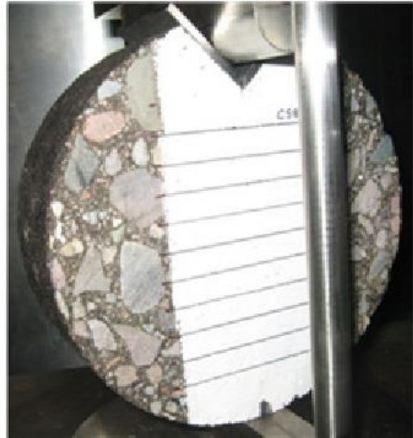
Рисунок 2.54 – Зовнішній вигляд та схематичне зображення зразка для випробування методом CFT, [228]
