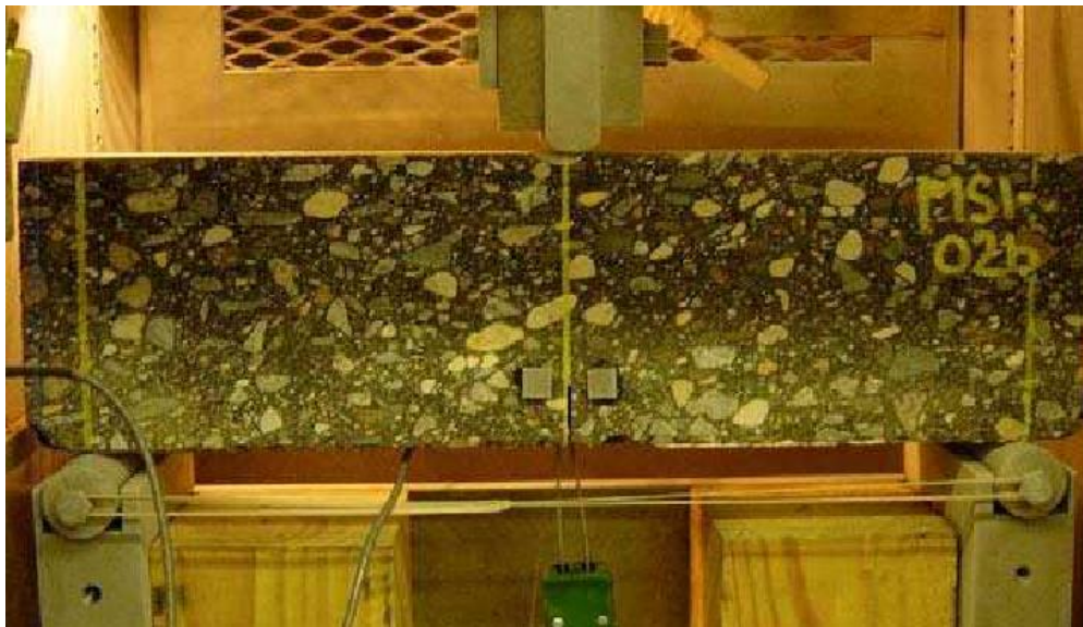
Рисунок 2.30 – Зовнішній вигляд зразка для випробування за методом SE(B) та обладнання для випробування, [177]
