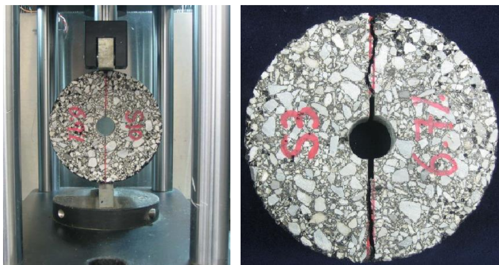
Рисунок 2.52 – Зовнішній вигляд асфальтобетонного зразка, підготовленого до випробування та зруйнованого, [227]
