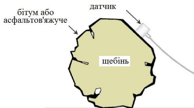
Рисунок 2.58 – Схема визначення температури розтріскування неуці- льненої асфальтобетонної суміші методом акустичної емісії, [232]
