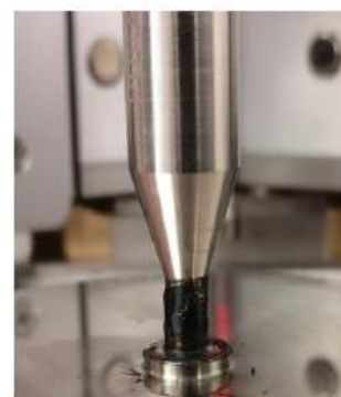
Рисунок 1.38 – Підготовка зразків за методом «DSR 4 мм», [78]
