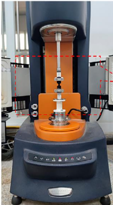
Рисунок 1.61 – Зовнішній вигляд реометру з встановленим зразком, [102]
