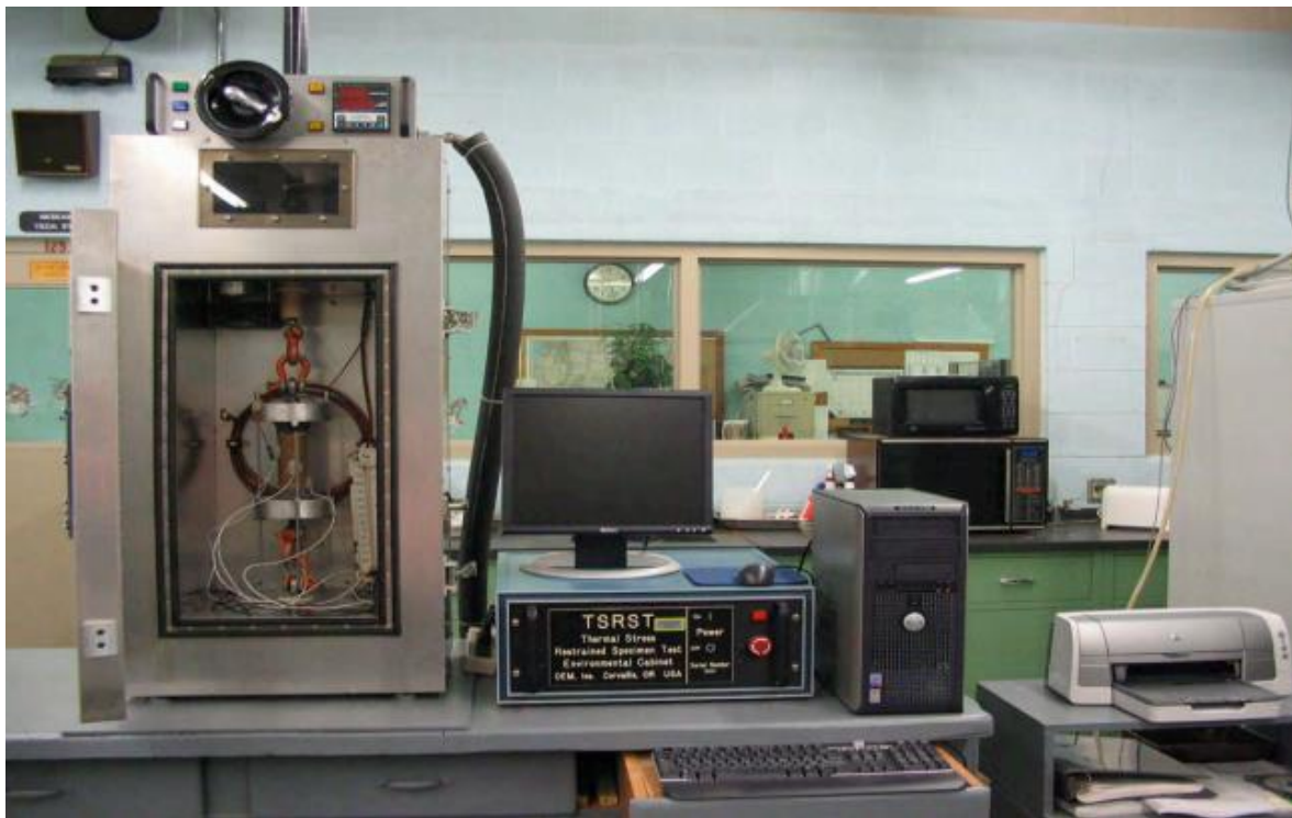
Рисунок 2.14 – Зовнішній вигляд установки TSRST, [134]
