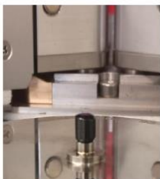
Рисунок 1.38 – Підготовка зразків за методом «DSR 4 мм», [78]
