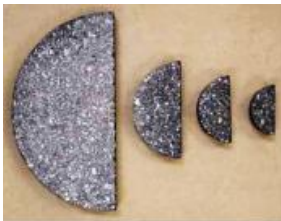
Рисунок 2.35 – Зовнішній вигляд асфальтобетонних зразків, що приймалися для визначення впливу розміру зразка на характер руйнування методом SCB, [187]
