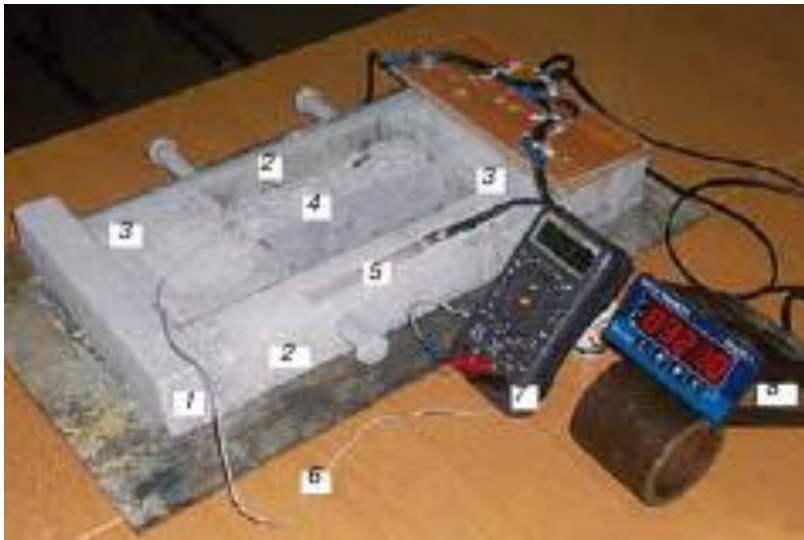
1 – поперечні пластини, 2 – бокові пластини, 3 – захвати, 4 – асфальтобетонний зразок, 5 – тензодатчик, 6 – термопара, 7 – вимірювач температури, 8 – тензоіндикатор Рисунок 2.67 – Зовнішній вигляд приладу УОНДА-1420, [239]
