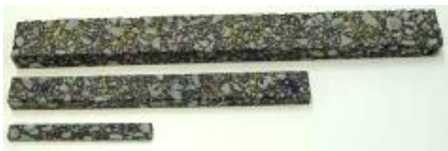
Рисунок 2.10 – Зразки різного розміру, що використовувалися для випробування методом ВВР, [125, 126]
