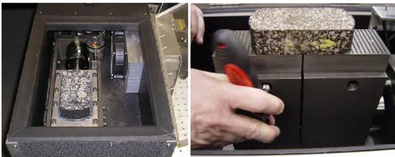
Рисунок 2.44 – Зовнішній вигляд зразка та приладу для випробування за Texas overlay test, [114]
