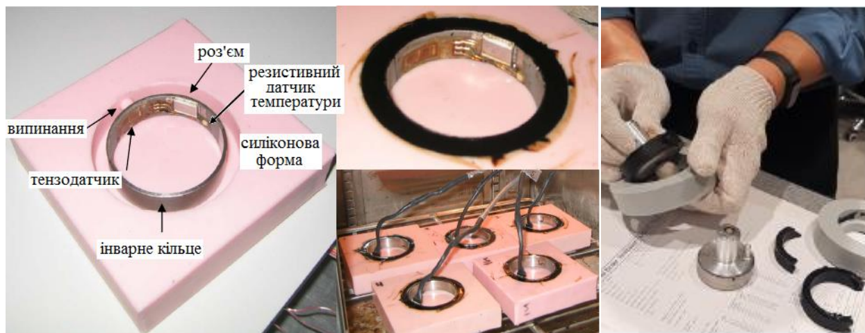
Рисунок 1.44 – Обладнання для випробування за ABCD, [85, 86]
