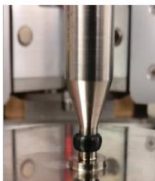
Рисунок 1.38 – Підготовка зразків за методом «DSR 4 мм», [78]
