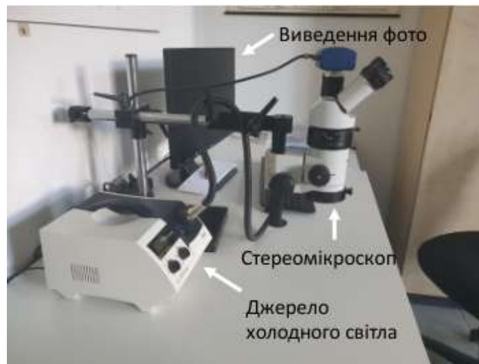
Рисунок 2.6 – Структура стереомікроскопа M3Z
