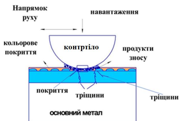
Рисунок 1 – Схематичне зображення фреттинг-зносу
