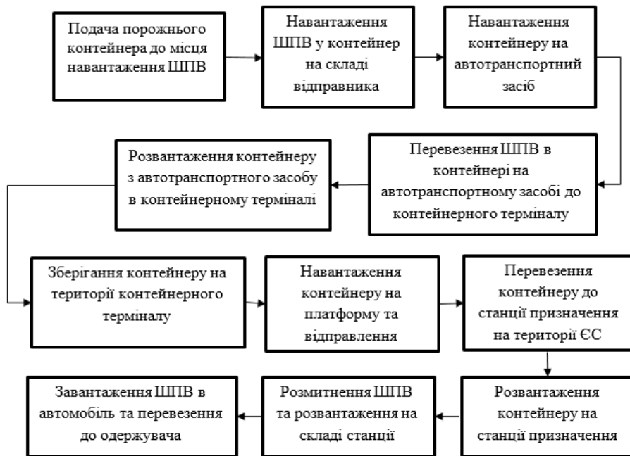
Рисунок 5. Схематичне представлення першого варіанту технології доставки ШПВ у контейнерах – «Схема 1»
