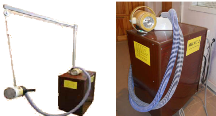
Рисунок 1 – Внешний вид комплекса для магнитно-импульсной рихтовки кузовов автомобилей
