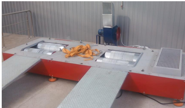
Рис. 1. Внешний вид одноосного нагрузочного динамометрического стенда VT-2
