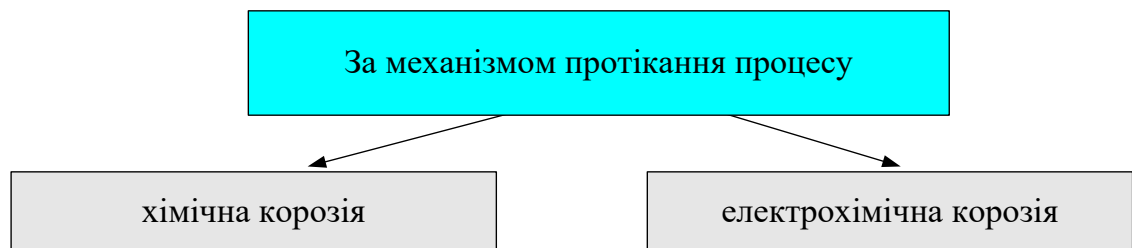
Рисунок 2 – Класифікація корозійних процесів за механізмом протікання процесу
