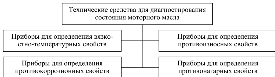
Рис. 1.80. Классификация технических средств диагностики состояния масла
