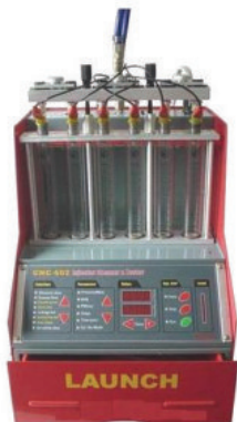
Рис. 1.55. Стенды моделей LAUNCH CNC-602A (а) и Триумф-4М (б) для контроля технического состояния и очистки форсунок
