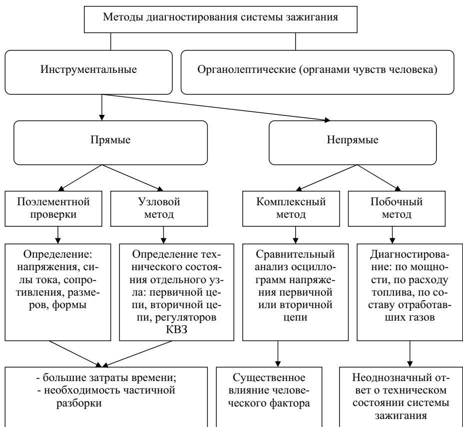
Рис. 1.25. Методы диагностирования системы зажигания
