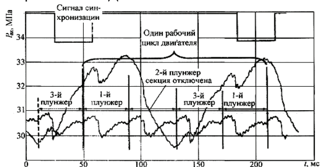
Рис. 2.62. Колебания давления при срабатывании 3-х и 2-х секций ТНВД
