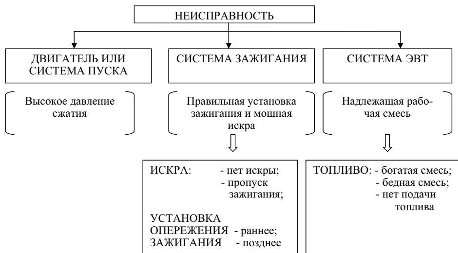
Рис. 2.19. Контроль системы ЭВТ
