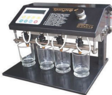
Рис. 1.55. Стенды моделей LAUNCH CNC-602A (а) и Триумф-4М (б) для контроля технического состояния и очистки форсунок
