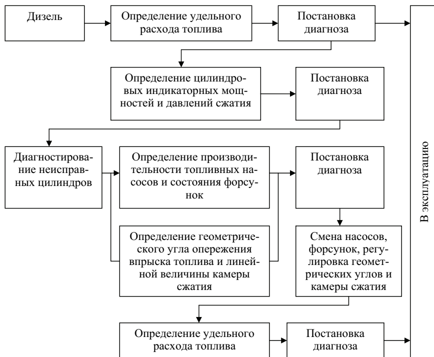
Рис. 2.41. Структурная схема диагностирования дизеля
