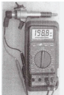
Рис. 2.125. Проверка шунтирующего сопротивления форсунки. Проверка емкости пьезоэлемента осуществляется аналогично
