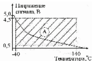
Рис. 2.16. Контролируемое блоком управления напряжение сигнала датчика с отрицательным температурным сопротивлением (NTC):
