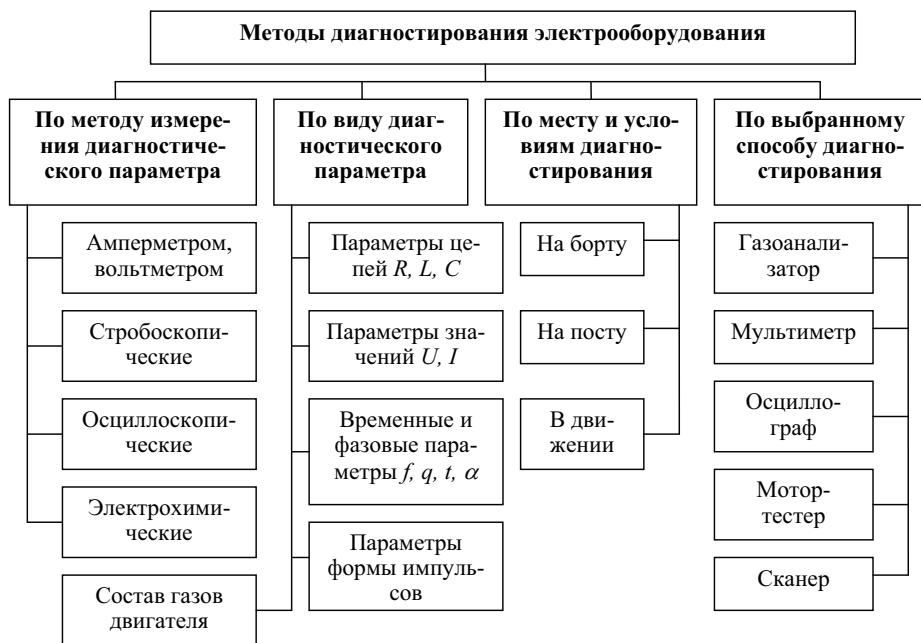
Рис. 2.145. Классификация методов диагностики электрических систем автомобиля
