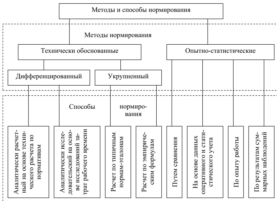
Рис. 1.11. Методы нормирования диагностических параметров состояния двигателя по прорыву газов в картер
