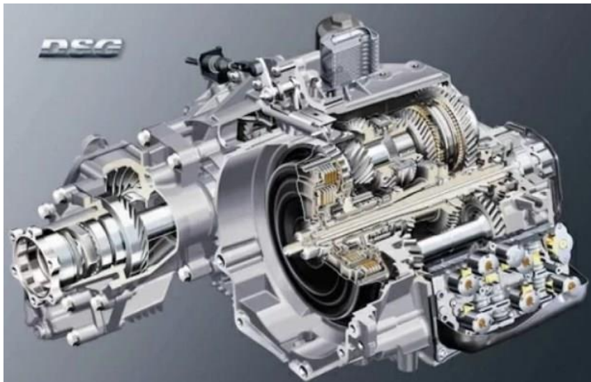
Рисунок 3 - Схема роботизованої коробки передач DSG 6/7
