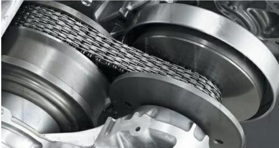
Рисунок 2 - Схема варіаторної АКПП
