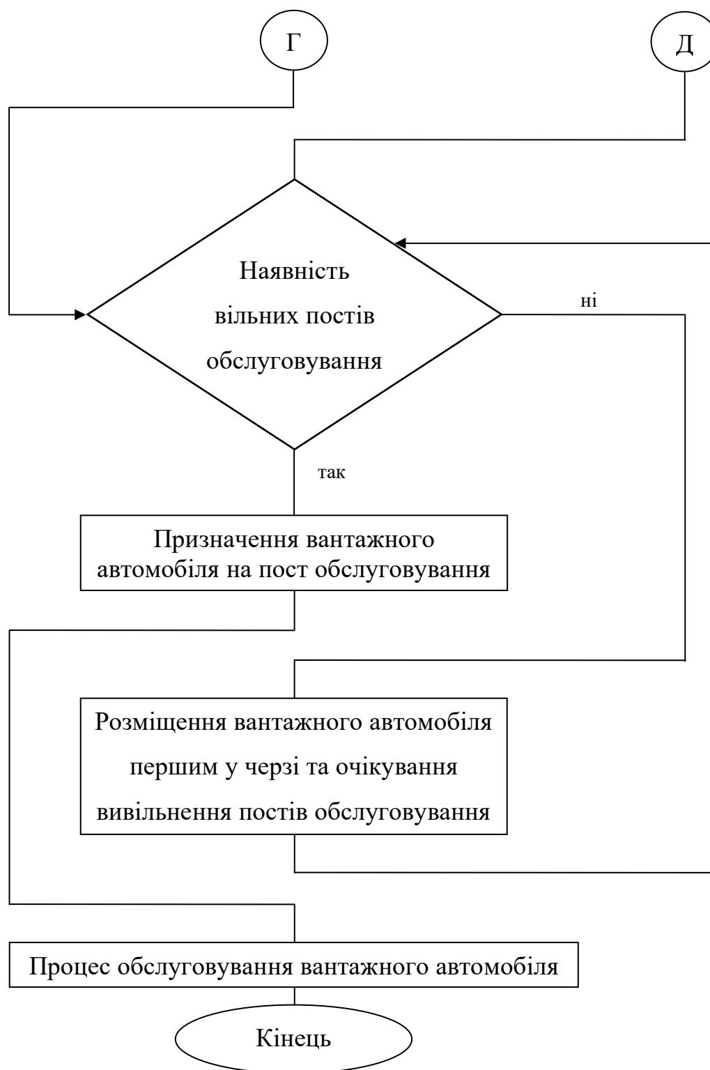
Рисунок 4.2 – Блок-схема стратегії обслуговування вантажних автомобілів у пунктах переробки вантажу
