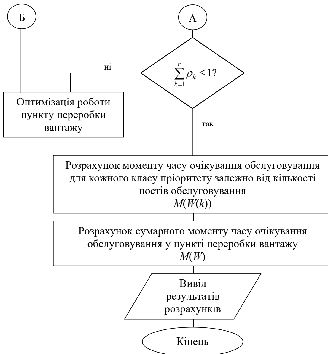
Рисунок 4.1 – Блок-схема алгоритму розрахунку моменту часу очікування обслуговування за пріоритетами
