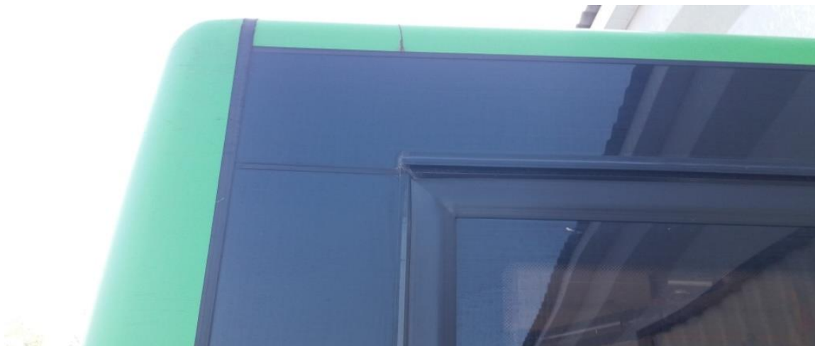
Рисунок 1 – Тріщина даху над задніми пасажирськими дверима
