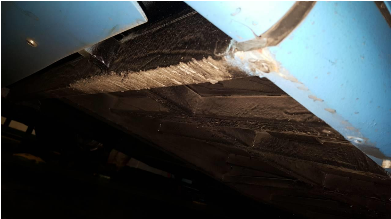
Рисунок 2 – Пошкодження поперечини в задній частині кузова
