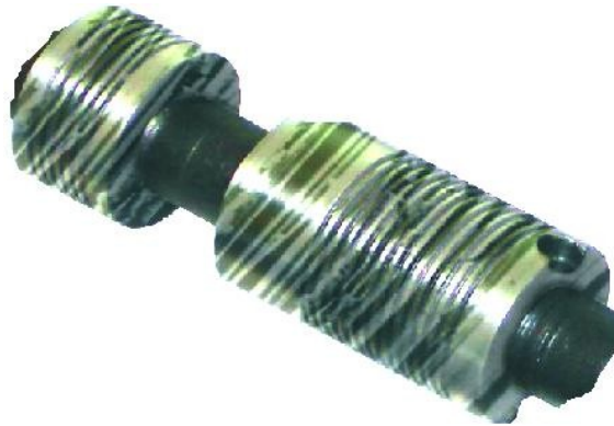
Рисунок 3.6, а – Зовнішній вигляд золотника з сталі 38X2МЮА після термообробки і шліфування
