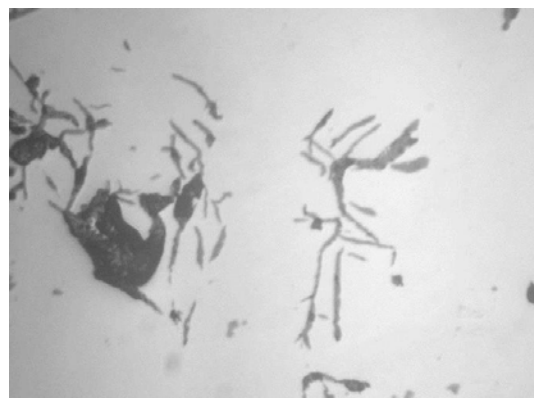
Рис. 2.9. Структура бочок чавунних валків виконання СПХН-43 у литому стані на відстані 30 мм від поверхні: колонії ледебуриту, графітної евтектики, перлітна матриця ( a ); форма графітних включень ( б ); a - травлення \text{HNO}_3 б - не травлено \times , 200
