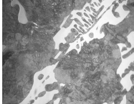
Рис. 2.8. Мікроструктура бочок валків виконання СПХН-45 ( a ) та СПХН-49 ( б ) на відстані 10 мм від поверхні в литому стані: форма графітних включень, травлення \text{HNO}_3 , \times 200
