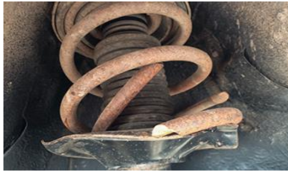
Рис.2-Лопнута пружина підвіски
