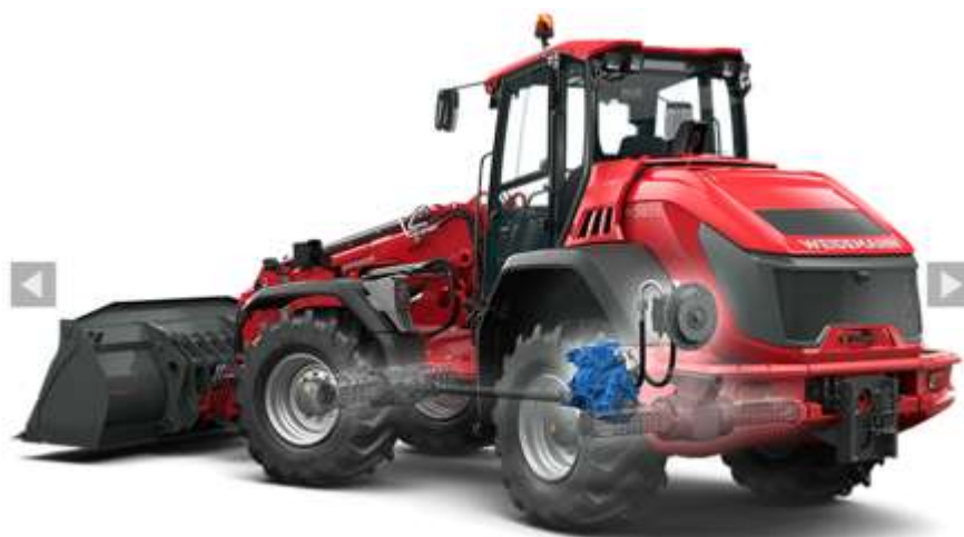
Рис. 1.5. Навантажувач Weideman 9080 з трансмісією на базі аксіальнопоршневого регульованого гідромотора, редуктора і карданних валів
