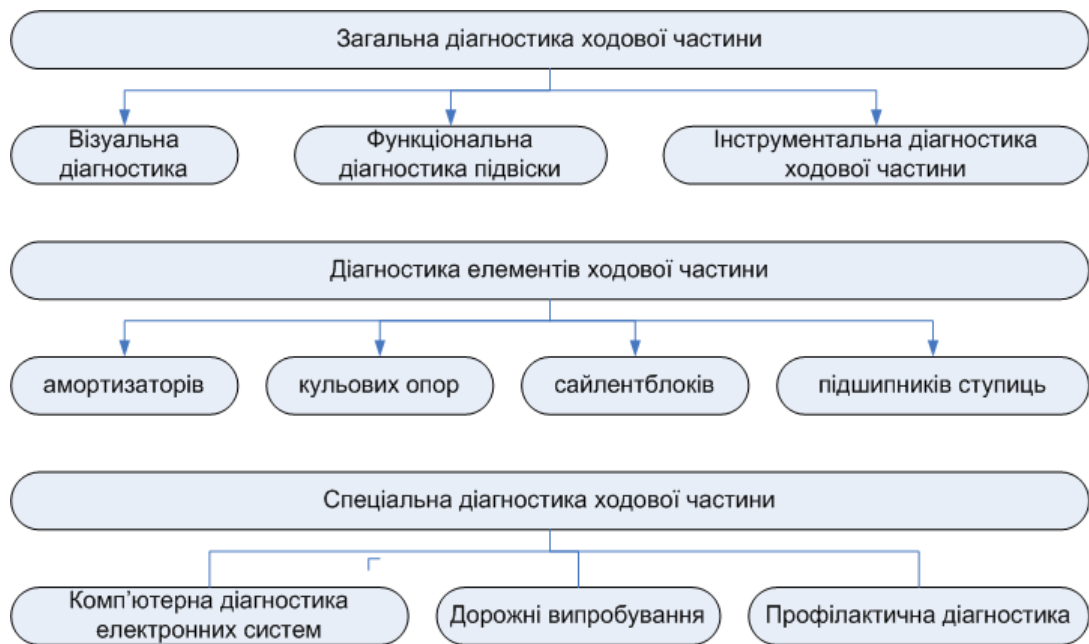
Рисунок 1 – Методи оцінки технічного стану підвіски автомобіля
