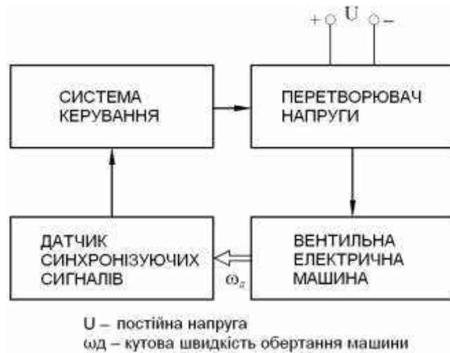
Рисунок 5 - Функціональна схема електропривода вентильного двигуна
