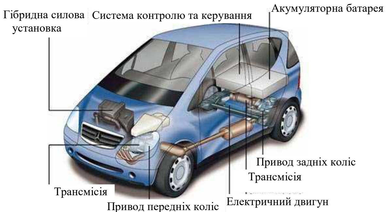
Рисунок 1 – Компонована схема гібридного автомобіля
