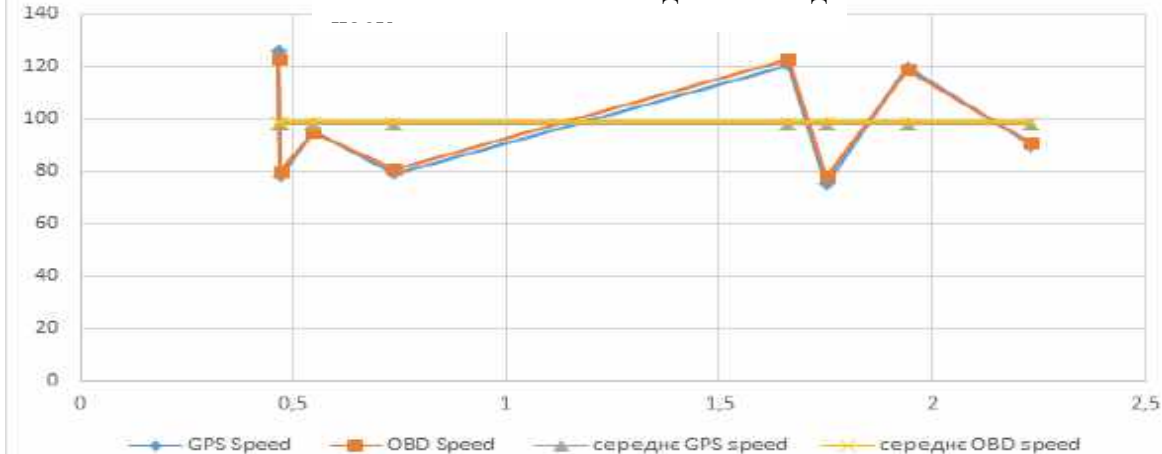
Рисунок 8 - Результати дослідження зміни максимальної швидкості руху ТЗ на дослідних дільницях в межах відстані шляху (варіант 3): a - в залежності від положення дільниці; б - в залежності від відстані шляху; в - в залежності від часу руху
