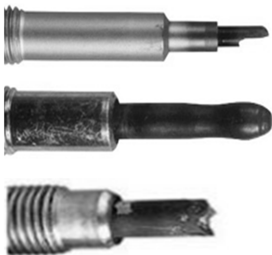
Рис. 4 – Руйнування свічок внаслідок аварійного живлення
