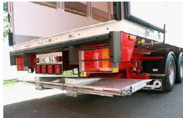
Рисунок 4 – Приклади встановлення гідравлічного борта-слайдера
