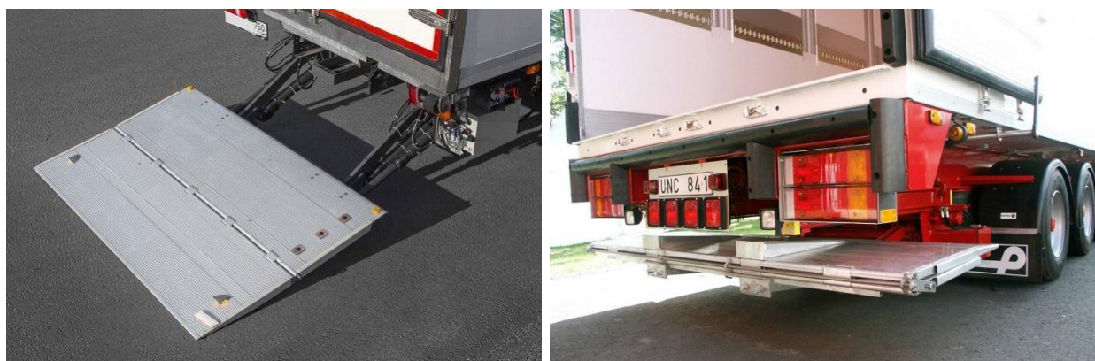
Рисунок 4.4 – Приклади встановлення гідравлічного борта-слайдера [11]
