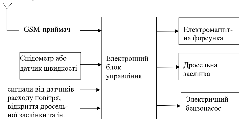
Рис. 1. Функціональна схема пристрою дистанційного примусового обмеження швидкості автомобіля
