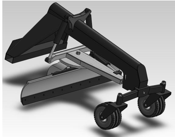
Рис. 7. Грейдерное рабочее оборудование к малогабаритному погрузчику
