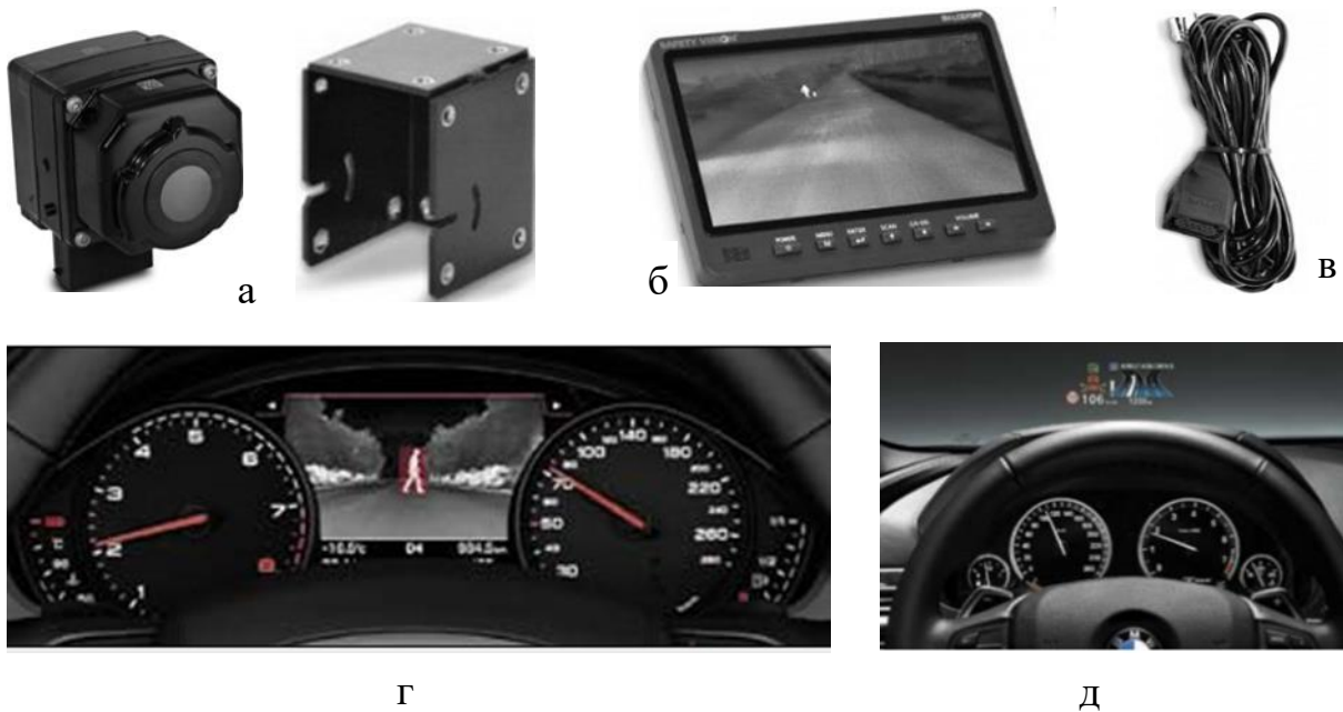
Рис. 10.9. Засоби відображення асистентів нічного бачення: а – теплова камера з захисним кожухом; б – монітор; в – комунікаційні кабелі; г – компоновка монітора; д – застосування проєкційного дисплею
