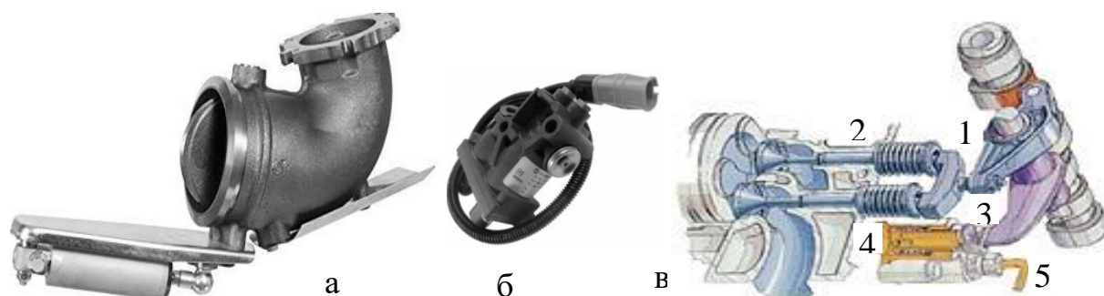
Рис. 7.36. Газодинамічні моторні сповільнювачі: а – компресійний сповільнювач; б – електроклапан; в – система декомпресійного сповільнення
