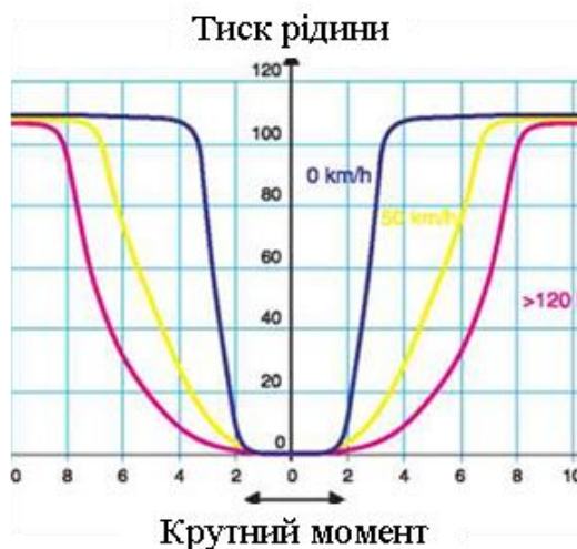
Рис. 6.4. Регулювальні характеристики підсилювача рульового керування
