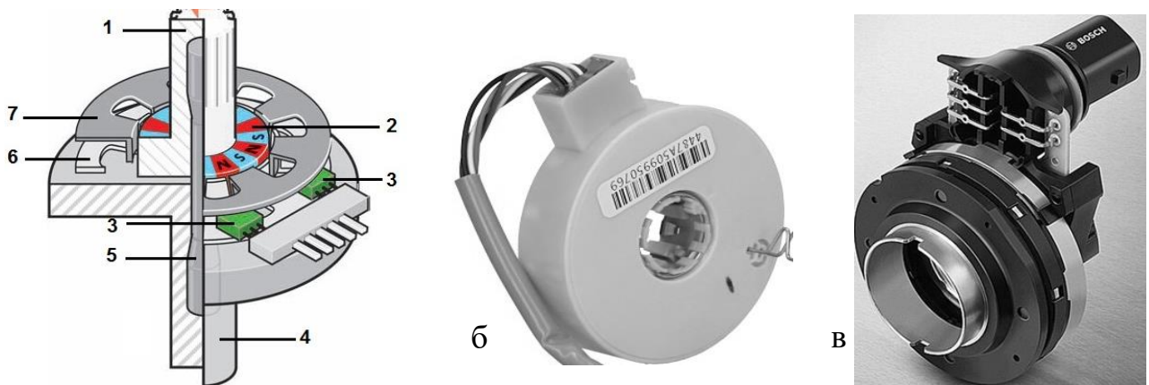
Рис. 6.5. Датчики крутного моменту: а – устрій; б, в – конструктивні виконання
