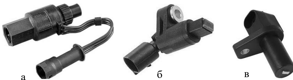
Рис. 6.10. Зовнішній вигляд датчиків суміжних електронних систем: а – швидкості руху автомобіля; б – швидкості обертання коліс; в – частоти обертання ДВЗ
