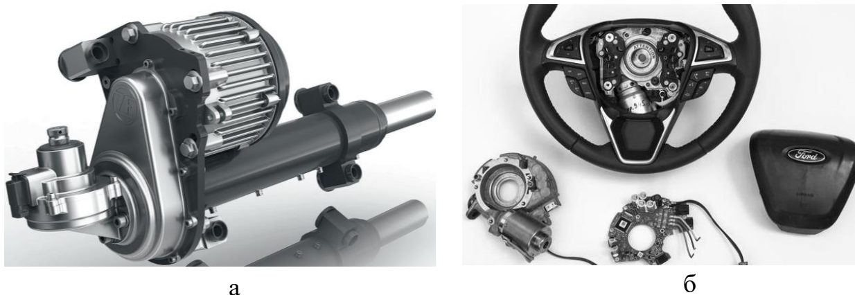
Рис. 6.22. Компоновка електричного приводу керма: а – на рульовому механізмі ReAX EPS; б – на ступці керма
