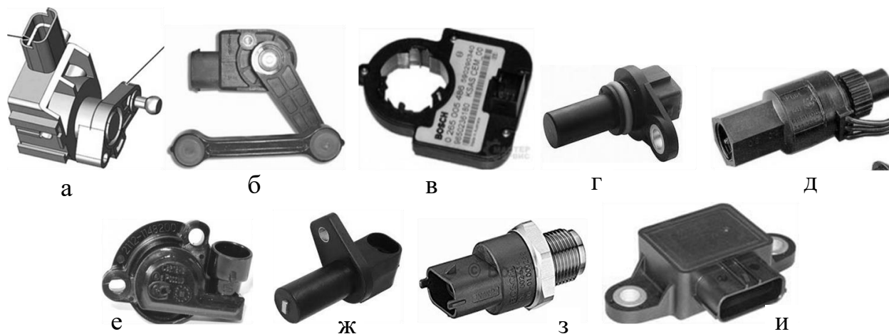
Рис. 8.35. Датчики системи керування Hydractive Plus : а, б – положення кузова; в – положення рульового колеса; г – кутової швидкості обертання коліс; д – ДША; е – ДПДЗ; ж – ДПКВ; з – тиску робочої рідини; и – прискорень кузова
