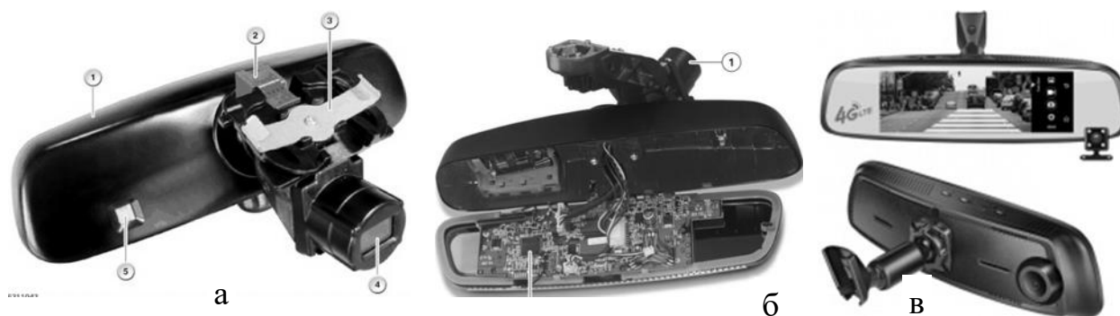
Рис. 10.7. Компонування елементів відіосистем: а, б – з камерою у внутрішньому дзеркалі заднього виду; в – з автономною камерою
