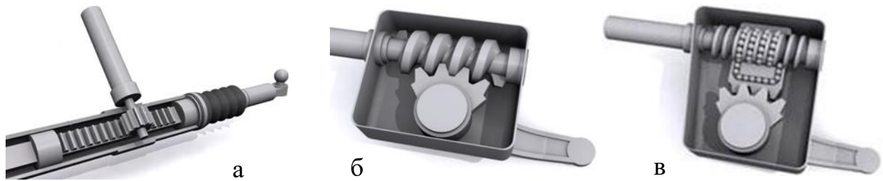
Рис. 6.1. Рульові механізми: а – рейка; б – черв'як; в – кулькова гайка
