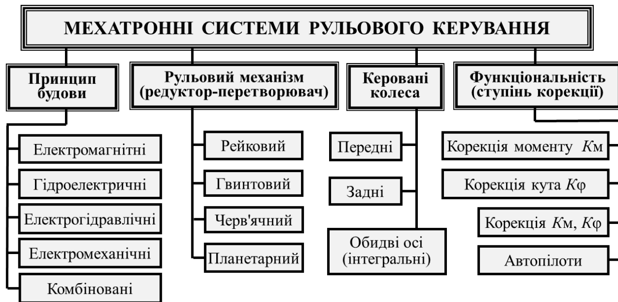
Рис. 6.2. Класифікаційна структура мехатронних систем рульового керування
