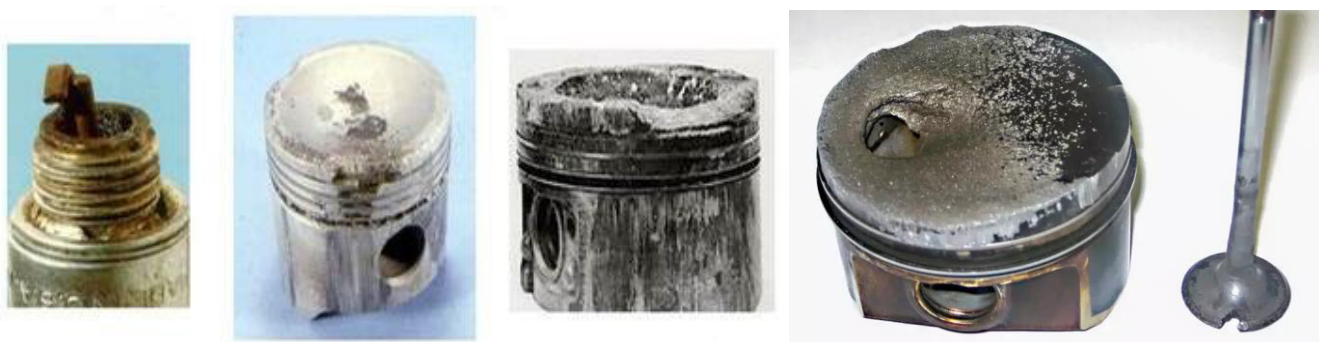
Рисунок 5 – Деталі двигуна зруйновані детонацією
