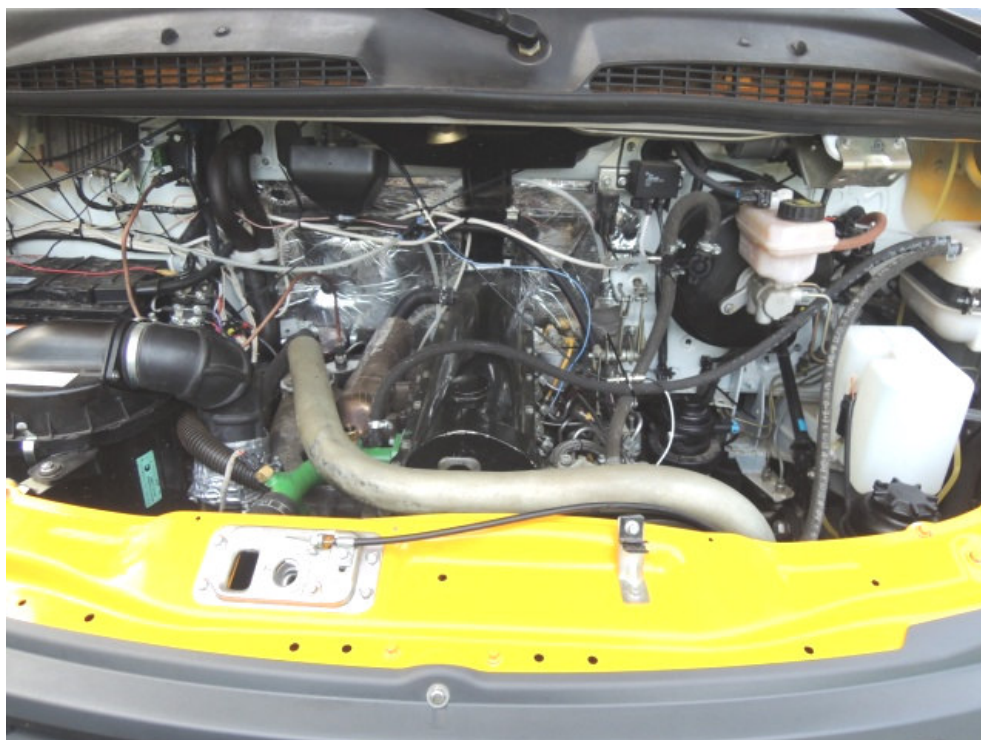
Рисунок 2.1 – Двигатель 4ДТНА1 в подкапотном пространстве автобуса
