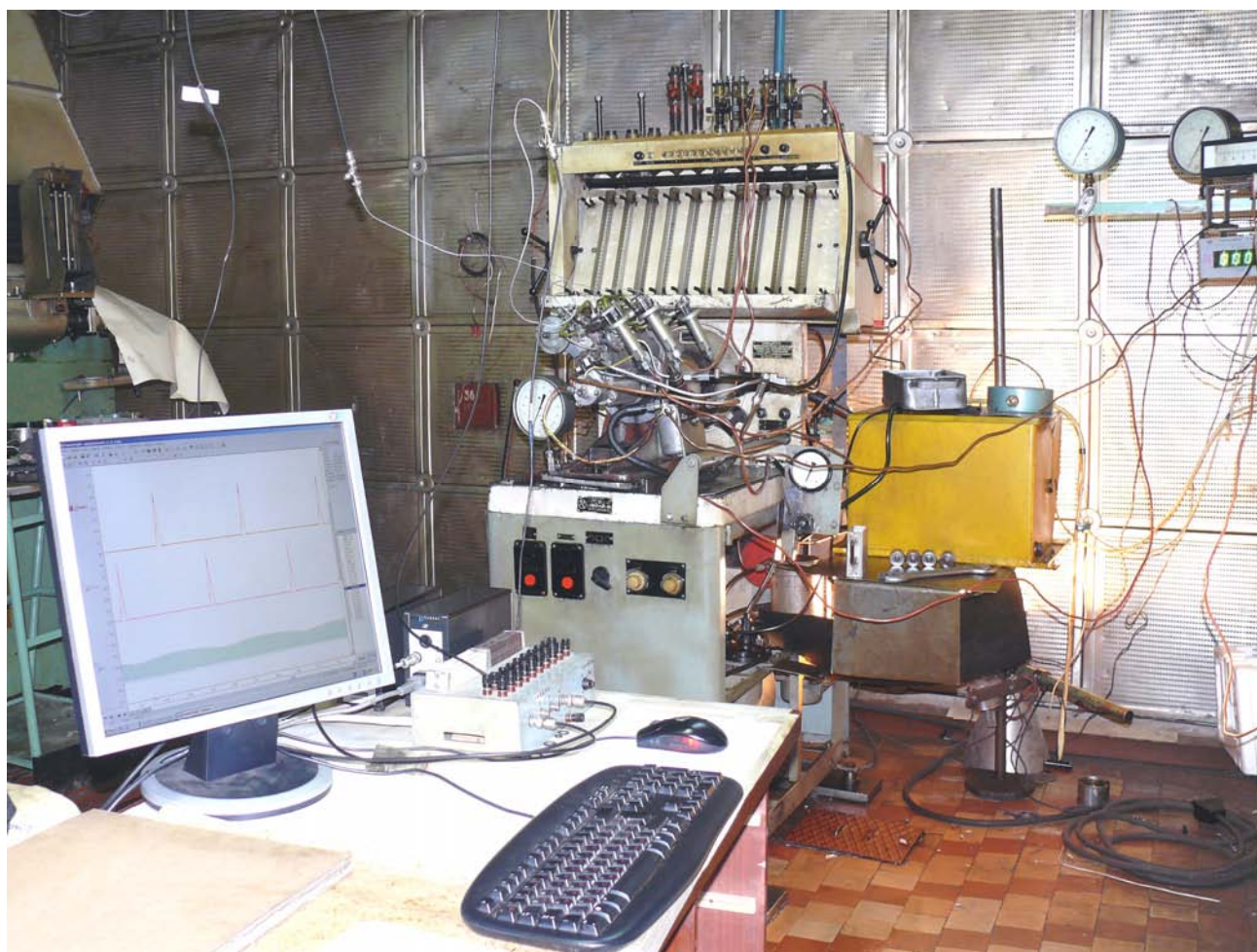
Рисунок 2.2 – Бокс лаборатории топливной аппаратуры ГП «ХКБД» с опытной ТПА на безмоторном стенде и подключенным к ней измерительным комплексом
