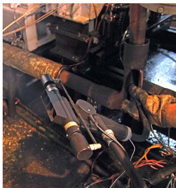
Рисунок 3.5 – Первичный измерительный преобразователь дымомера с газоотборным зондом в выпускном коллекторе дизеля
