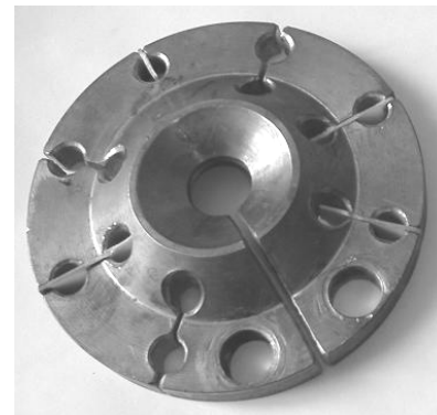
Рис. 1. Индукторная система из одновиткового соленоида с внутренним отверстием конической формы: а – расчётная модель, 1 – виток индуктора, плоская листовая заготовка, 2 – (\vec{e}_r, \vec{e}_\varphi, \vec{e}_z) – направляющие орты цилиндрической системы координат); б – собственно индуктор в экспериментах
