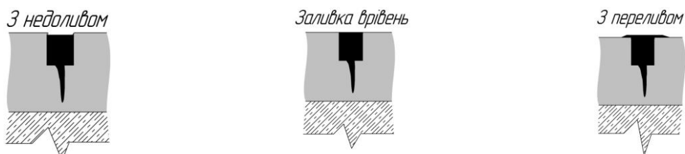
Рисунок 5 – Заливка герметика у тріщини
