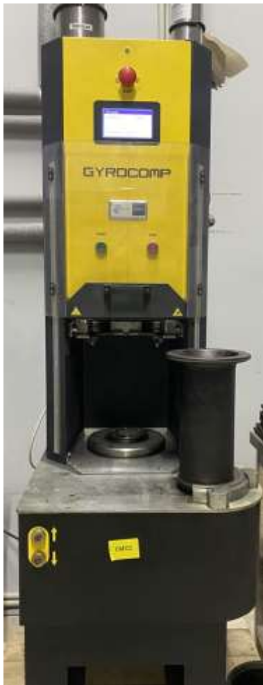
Рисунок 2.1 – Гіраторний ущільнювач CONTROLS з аксесуарами (форми діаметром 100 та 150 мм)
