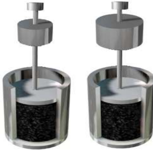
Рисунок 1.1 – Попереднє ущільнення асфальтобетонної суміші трамбовками методом Хаббарда-Фильда
