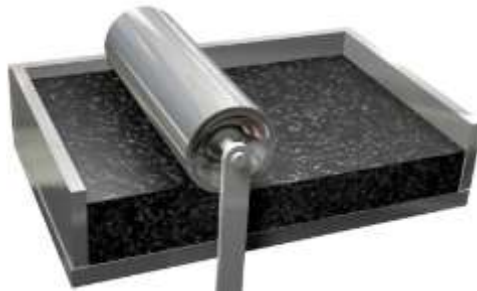
Рисунок 1.8 – Ущільнення асфальтобетонної суміші роликовим ущільнювачем
