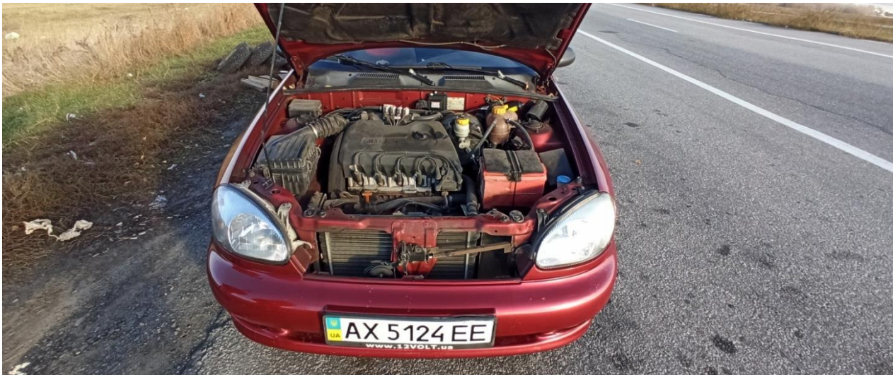
Рисунок 1 – Моторний відсік автомобіля Daewoo Sens зі встановленим газовим обладнанням
