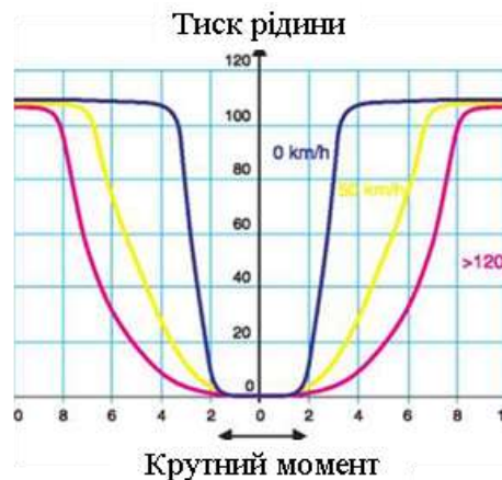
Рис. 1.4. Регульовальні характеристики підсилювача рульового керування
