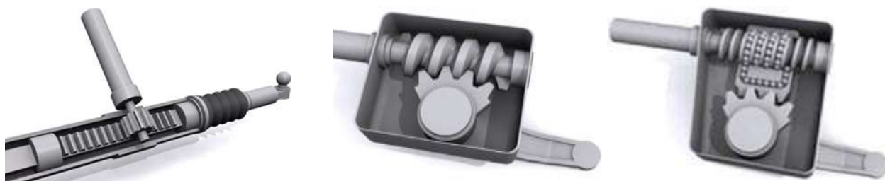
Рис. 1.1. Рульові механізми: а – рейка; б – черв'як; в – кулькова гайка
