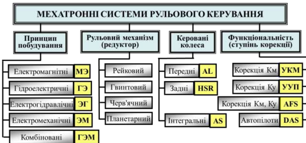
Рис. 1.2. Класифікаційна структура мехатронних систем рульового керування
