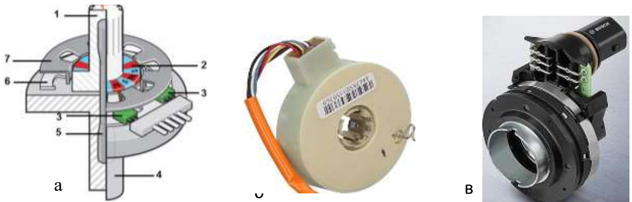
Рис. 1.5. Датчики крутного моменту: а – устрій; б, в – конструктивні виконання
