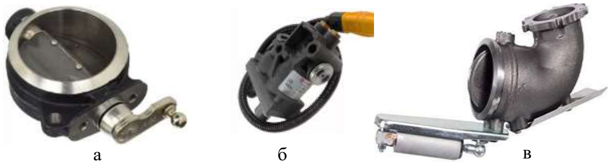
Рис. 2.25. Компресійний сповільнювач з пневмоприводом: а – газова заслінка; б – електроклапан; в – агрегат у зборі
