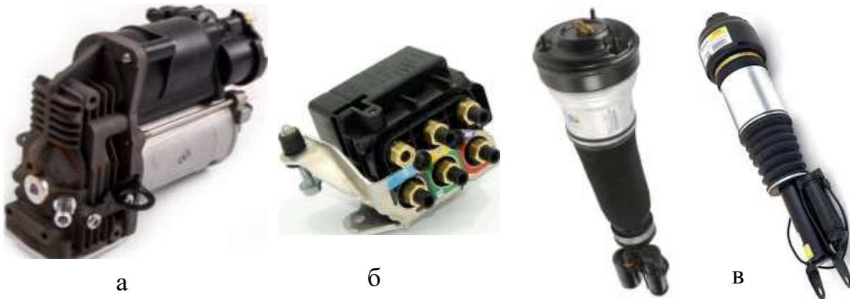
Рис. 3.22. Компоненти системи Airmatic: а – інтегрований модуль; б – блок клапанів; в – пневматичні стійки
