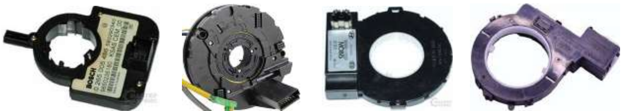
Рис. 1.7. Варіанти конструкцій датчиків кута повороту рульового колеса
