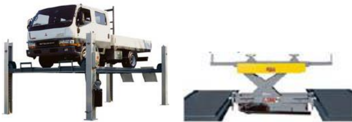
Рис. 3.19. Підйомник чотирьохстійковий електрогідравлічний для проведення слюсарних робіт
