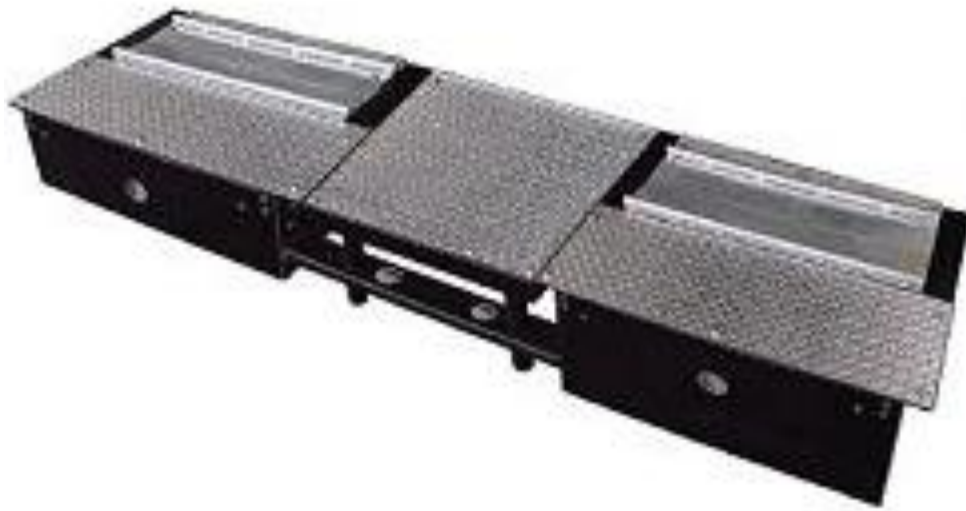
Рис. 10.4. Тестер підвіски EUSAMA ST200 E-NX
