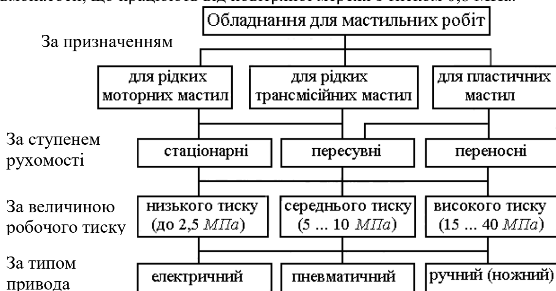
Рис. 5.1. Класифікація обладнання для мастильних робіт
