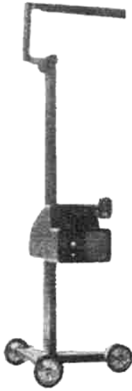
Рис. 13.17. Прилад для перевірки й регулювання світла фар автомобілів, модель «FOCUS» фірми «DIP DIVISION» (Італія)
