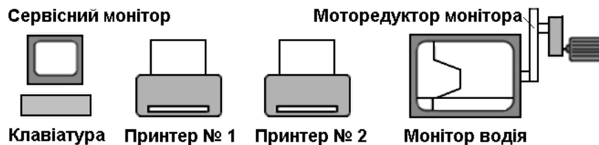
Рис. 7.7. Реєструючі пристрої роликового стенда М-108
