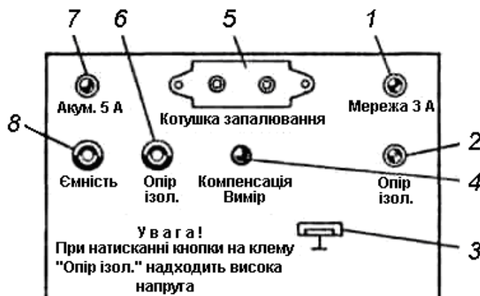
Рис. 13.11. Панель підключення перевірюваних приладів до стенда СПЗ-8М:
