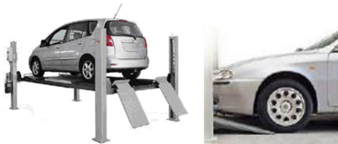
Рис. 3.20. Підйомник чотирьохстійковий електрогідравлічний під «розвал-сходження»
