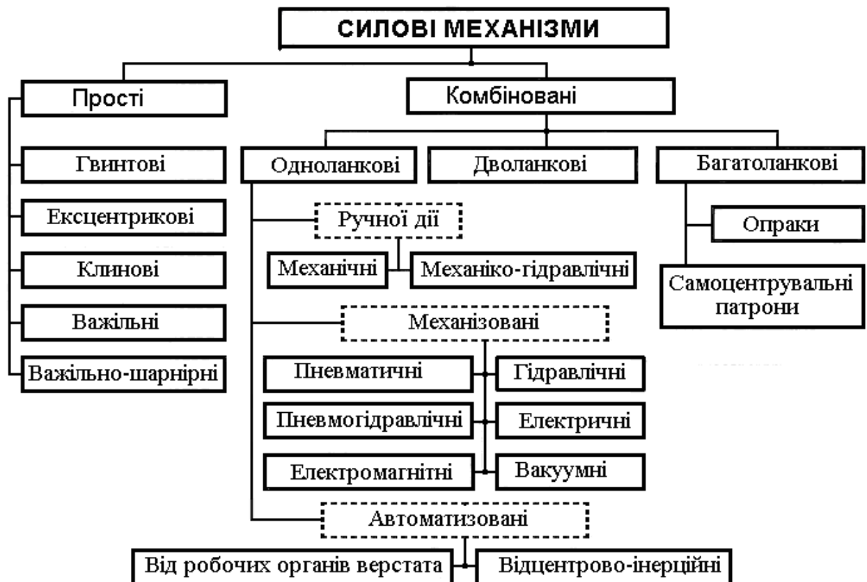
Рис. 19.1. Класифікація силових механізмів гаражного устаткування
