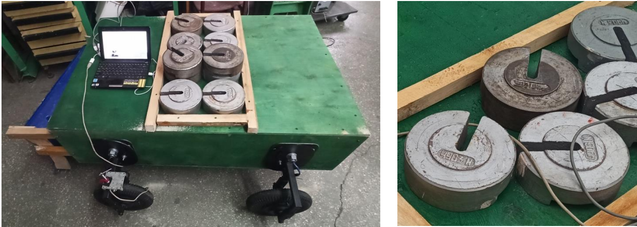
Рисунок 2 – Вантажі, що використовувались для зміни маси безпілотного колісного візка в процесі експериментального дослідження
