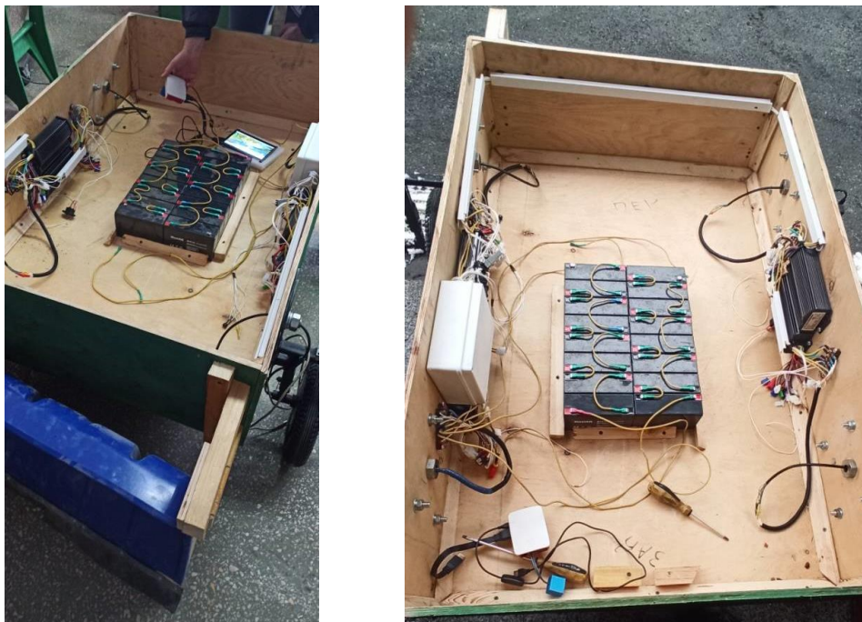
Рисунок 3 – Блок акумуляторних батарей та система керування безпілотного колісного візка
