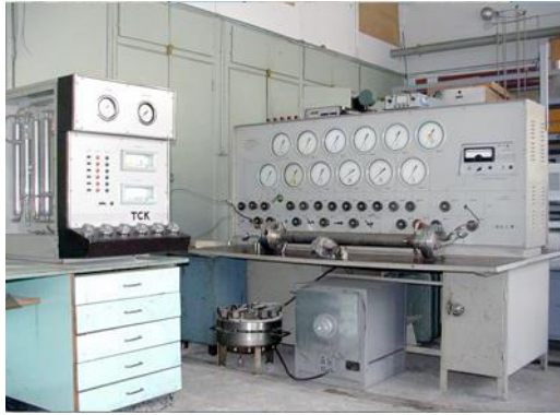
Рис. 1.6. Загальний вигляд станда для дослідження фазових рівноваг у системі «металогідрид–водень»
