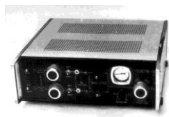
Рис. 3.19. Лабораторний акумулятор-нагнітач водню Омега-10 для зберігання та очищення водню
