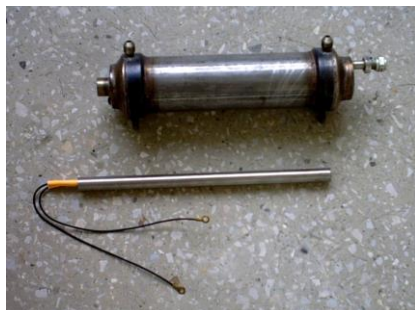
Рис. 2.35. Генератор-сорбер з електронагрівачем та теплопередаючою матрицею
