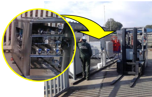
Рис. 5.15. Дослідно-промисловий зразок одноступінчастого металогібридного ТСК (50-200 бар/13 нм 3 /год), інтегрованого у водневу заправну станцію на аффінажному заводі “Impala Platinum Refineries” (м. Спрінгс, ПАР). Компресор та заправна станція використовують заводську інфраструктуру, включаючи трубопровід подачі водню (50-60 бар), низькосортну пару (~140 °С), оборотну охолоджуючу воду (15-20 °С) і стиснуте повітря (5,5-7,5 бар). Споживана електрична потужність до 2 кВт [5, 6]
