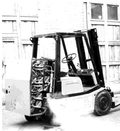
Рис. 3.16. Загальний вигляд водневого варіанта автовантажувача моделі 4092-01 (знімок зроблено узимку при працюючому двигуні)
