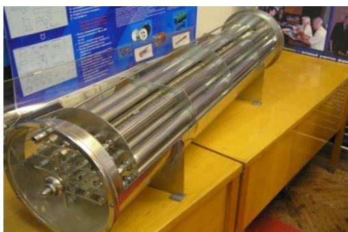
Рис. 3.8. Загальний вигляд металогібридної системи для акумулювання водню
