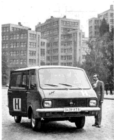
Рис. 3.24. Загальний вигляд експериментального зразка водневого автомобіля на базі мікроавтобуса
