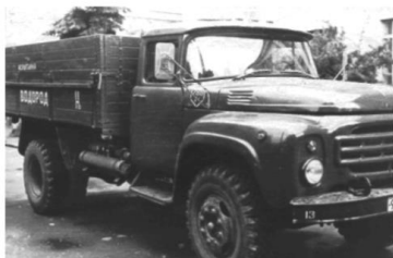
Рис. 3.22. Перший у СРСР вантажний автомобіль ЗІЛ-130 на бензоводневому паливі
