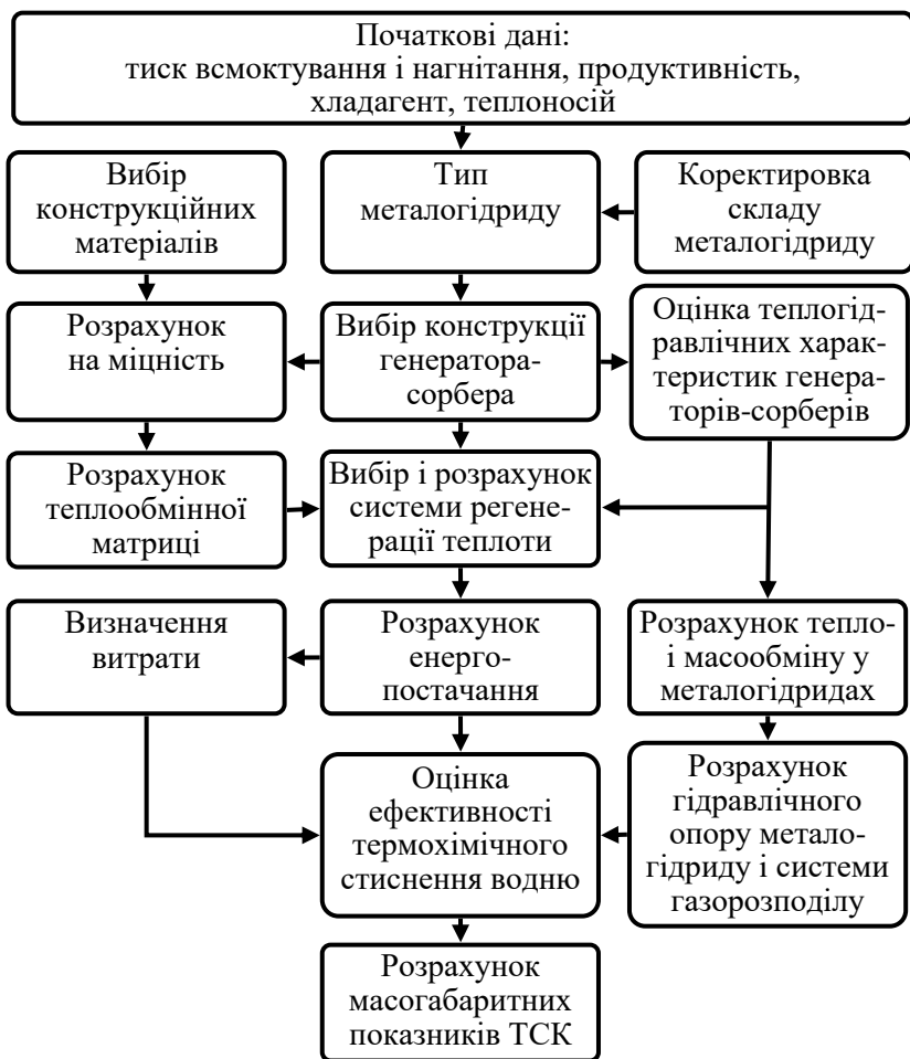
Рис. 5.2. Схема розрахунку конструкції металогідридних термосорбційних компресорів
