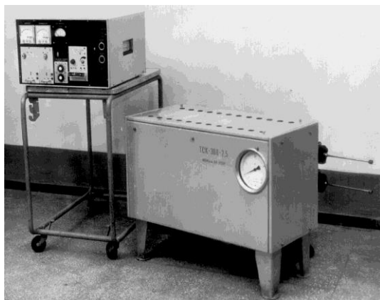
Рис. 5.6. Термосорбційний компресор ТСК-300-2,5 з блоком керування
