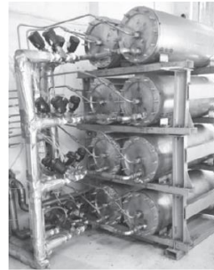
Рис. 5.14. Дослідно-промисловий зразок двохступінчастого металогібридного ТСК (3,5-150 бар/15 нм 3 /год). Розробники – ІПХФ РАН, ОАО СКТБЕ (Росія) [4]
