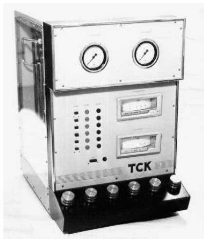
Рис. 5.4. Термосорбційний компресор ТСК-150-2,5
