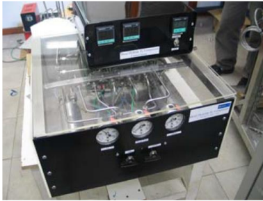
Рис. 5.13. Лабораторний зразок двохступінчастого металогібридного ТСК (7-200 бар/60 нл/год). Розробник – Південноафриканський інститут хімії передових матеріалів (SAIAMC, ПАР) [3]
