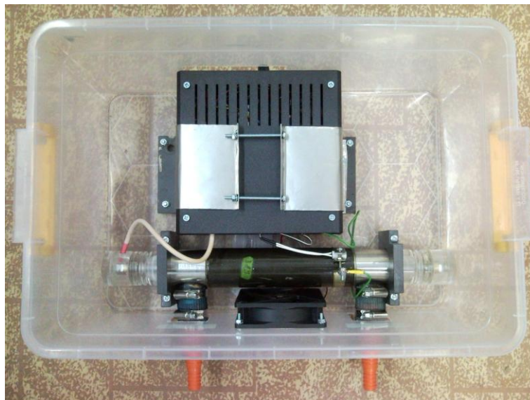
Рисунок 6 – Фотографії прототипу озонатора для додатків з потребами невеликої кількості озону в озон-повітряній суміші
