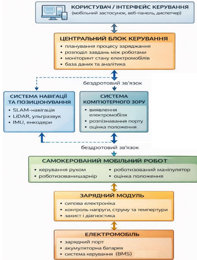
Рисунок 1 – Структурна схема інтелектуальної системи автоматичного заряджання електромобілів
