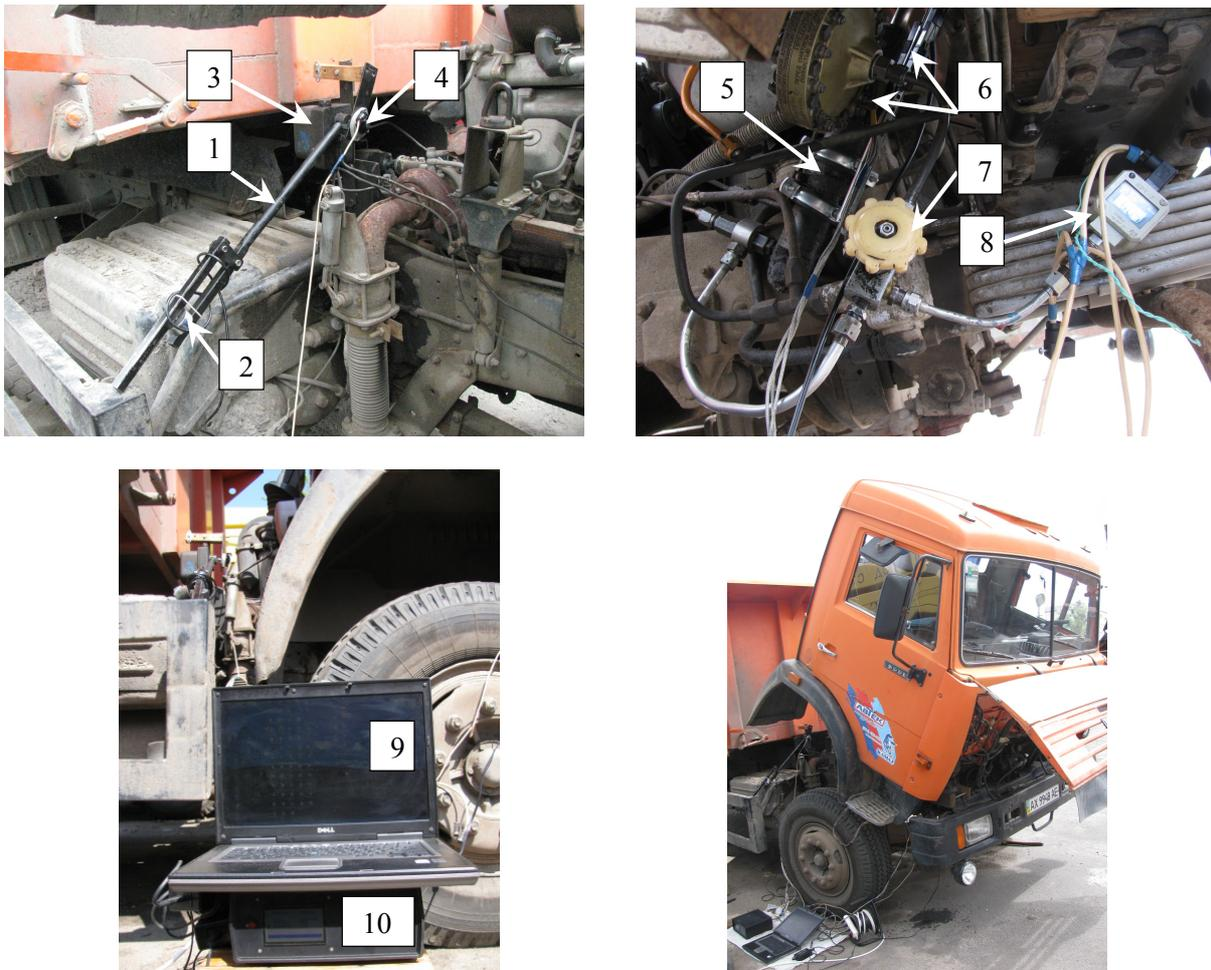
Рис. 4. Расположение компонентов и измерительно-регистрающего комплекса при исследовании гидравлического механизма опрокидывания кабины: 1 – рукоятка; 2 – датчик усилия; 3 – насос; 4 – датчик угла поворота приводного вала насоса; 5 – гидроцилиндр; 6 – датчики перемещения штока гидроцилиндра; 7 – вентиль; 8 – датчик давления; 9 – ноутбук; 10 – БОС
