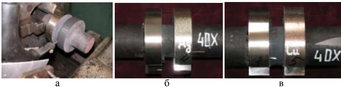
Рис. 3. Зразки зі сталі 40X після ЦЕЛ (а) і ЕЛ сріблом (б) і міддю (в)
