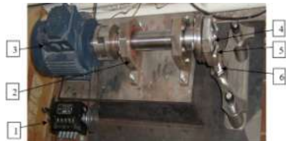
Рис. 5. Стенд для дослідження фретингостійкості: 1 – лічильник циклів; 2 – станина з підшипниковими опорами; 3 – електропривод; 4 – ексцентриковий механізм; 5 – пакет із гнучких елементів; 6 – механізм кріплення гнучких елементів
