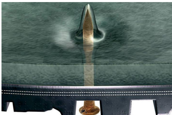
Рисунок 3 – Технологія самозаклейки шини
