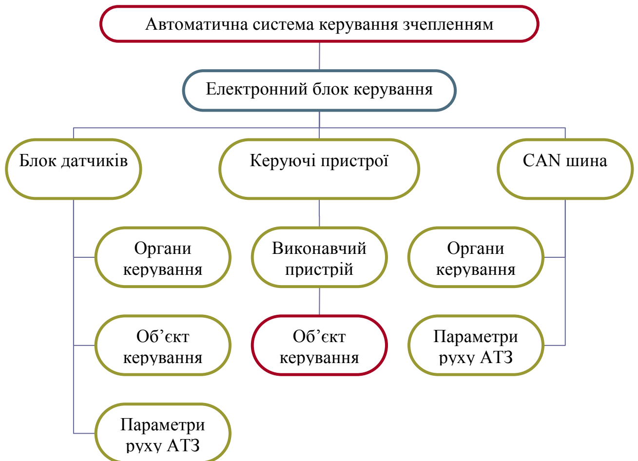
Рис. 1.9. Структурна схема автоматичної системи керування фрикційним зчепленням
