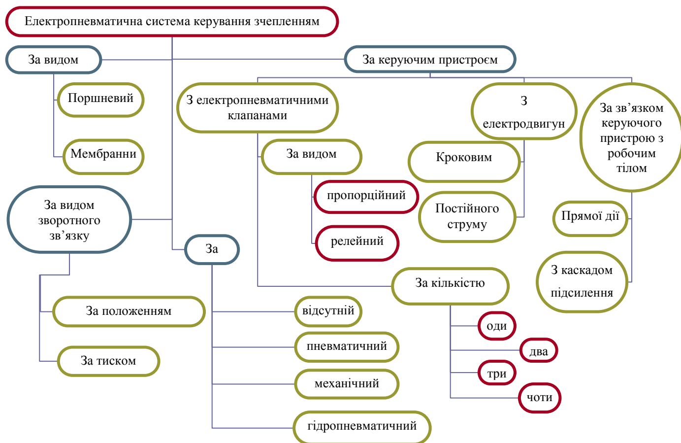
Рис. 1.10. Класифікація електропневматичних систем керування зчепленням
