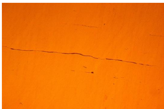
Рисунок 1 – Неметалеві вкраплення у сталі 34ХН1МА (сульфїди, 4 бал), \times 250
