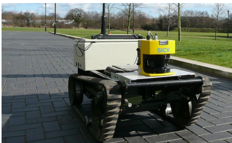
Рисунок 2 – ЛІДАР, встановлений на мобільному роботі [1]
