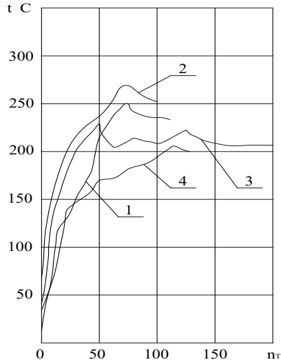
Рис. 6.23. Криві нагріву гальмівного диска при B_p = 12 мм і \Delta\tau = 60 с (гальмо за схемою 5): 1 – досвід перший; 2 – досвід другий; 3 – досвід третій; 4 – досвід четвертий
