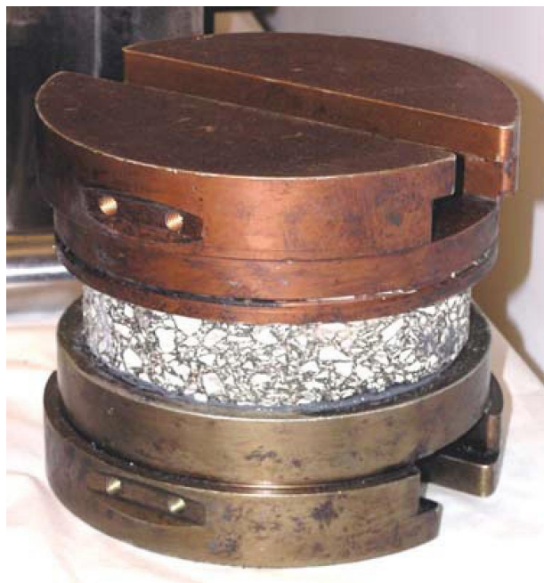
Рисунок 1 – Зразок асфальтобетону, затиснений в захватці навантаження приладу SST
