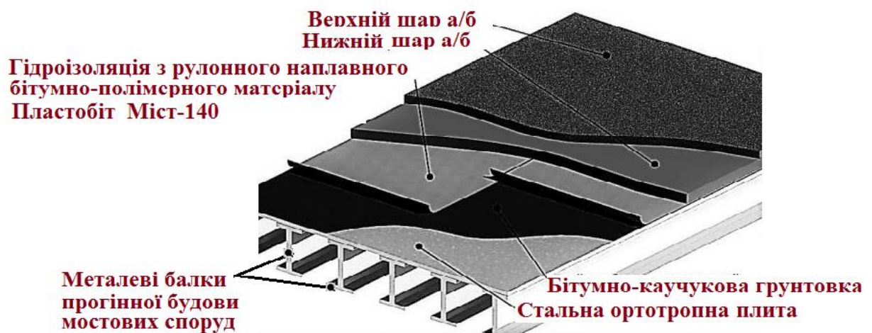
Рисунок 1 - Шари покриття проїзної частини металевих мостів і шляхопроводів при улаштуванні обклеєчної гідроізоляції із бітумно-полімерного рулонного матеріалу Пластобіт Міст 140
