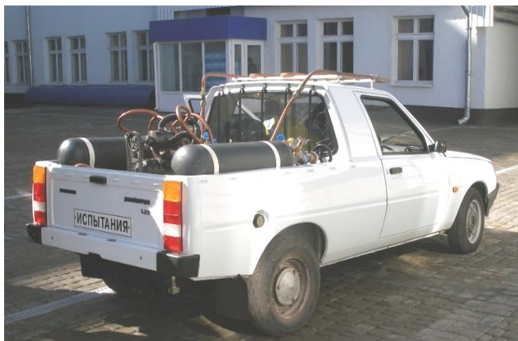
Рисунок 4 – Автомобіль, обладнаний гібридною силовою установкою схеми «ДВЗ – пневмодвигун»
