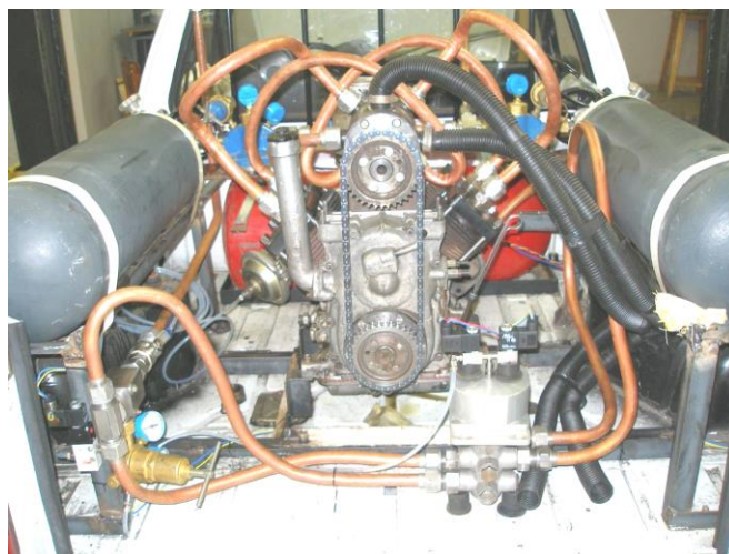
Рисунок 3 - Поршневий пневмодвигун, встановлений на гібридній силовій установці автомобіля, для проведення дорожніх випробувань
