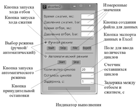
Рис.4. Интерфейс управляющей программы Программное обеспечение позволяет: - управлять стендом как в ручном так и в автоматическом режиме;
