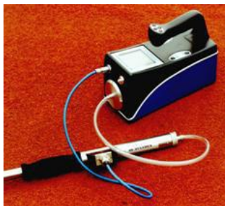
Рисунок 2– Газоаналізатор Escorprobe-5 із підключеним зондом
