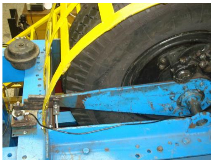
Рис. 8.8. Установка датчика усилия LPX-10000 на стенде
