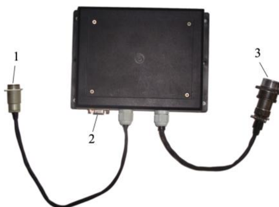
Рис. 7.8. Общий вид электронного блока управления
