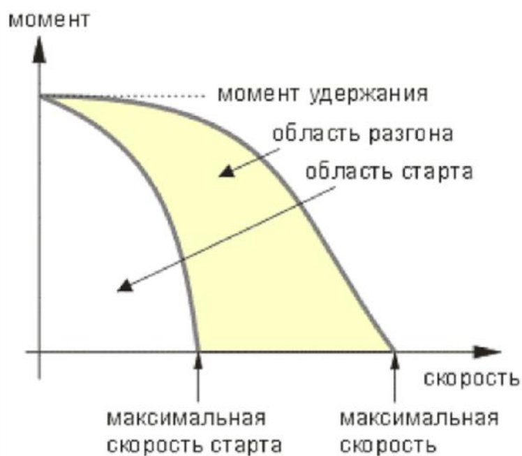
Рис. 7.12. Зависимость момента от скорости шагового электродвигателя
