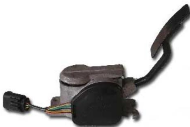
Рис. 7.2. Общий вид модуля педального КДБА.453621.001ТУ и его принципиальная электрическая схема
