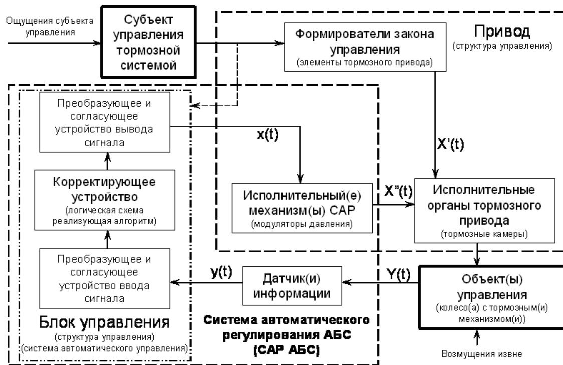
Рис. 3.1. Структурная схема тормозного управления с системой автоматического регулирования ABS
