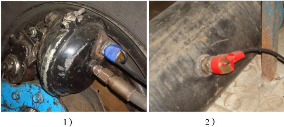
Рис. 8.5. Установка датчиков MPX 5999D на стенде: 1) – для определения давления в тормозной камере; 2) – для определения давления в ресивере
