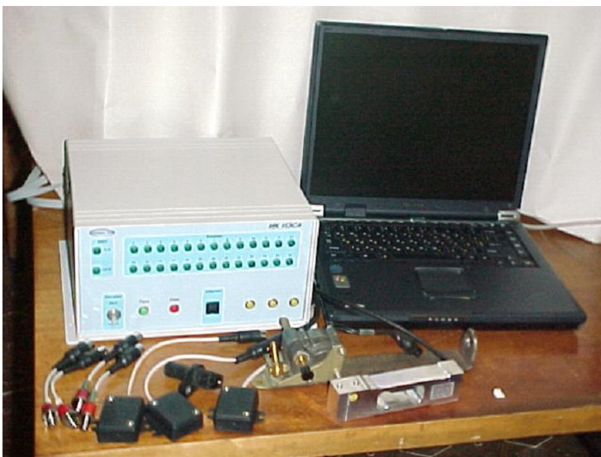
Рис. 5.13. Общий вид измерительного комплекса ИК ИЭСА и датчиков ходовой лаборатории кафедры «автомобилей»
