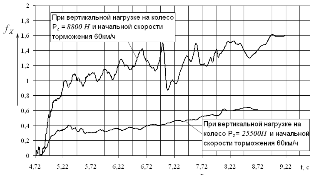
Рис. 4.27. Экспериментальные зависимости реализуемого сцепления шины 11,00-R20 в зависимости от времени, при качении колеса на пределе блокирования под действием АБС
