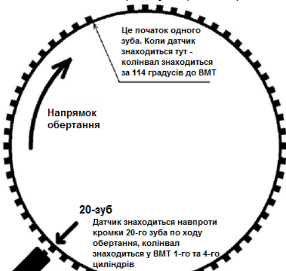
Рис. 2.5 – Рахунок зубів на диску синхронізації
