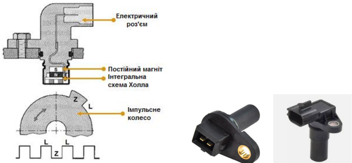
Рис. 2.13 – Пристрій датчика Холла та форма його сигналу
