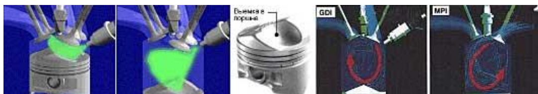
Рис.3.4 – Основні конструктивні відмінності системи безпосереднього впорскування
