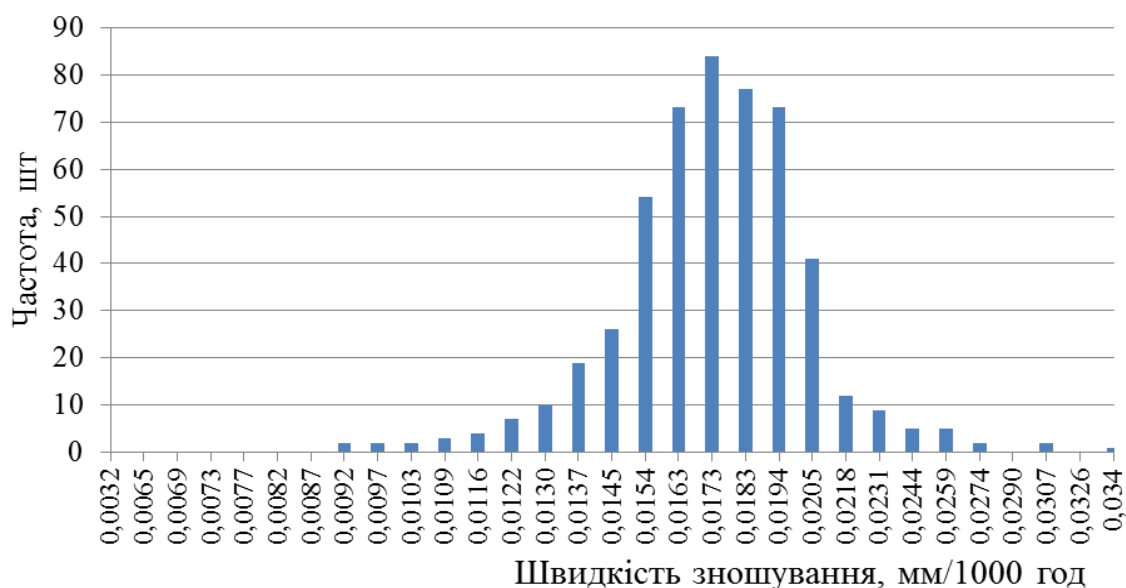
Рисунок 1 – Полігон розподілення швидкості зношування циліндрових втулок двигунів Hyundai-Himsen типу H21/32 та H25/33
