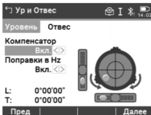
Рис. 1.4. Наведення електронного рівня в нуль-пункт [2]
