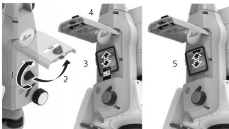
Рис. 6.3. Вставлення SD-карти: 1 – повернення засувки на кришці відсіку для його відкриття; 2 – відкриття кришки відсіку; 3 – вставлення SD-карти; 4 – закривання кришки і повернення засувки для закривання; 5 – отримання карти [2]
