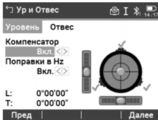
Рис. 1.6. Підказка точно відгоризнтованого приладу [2]
