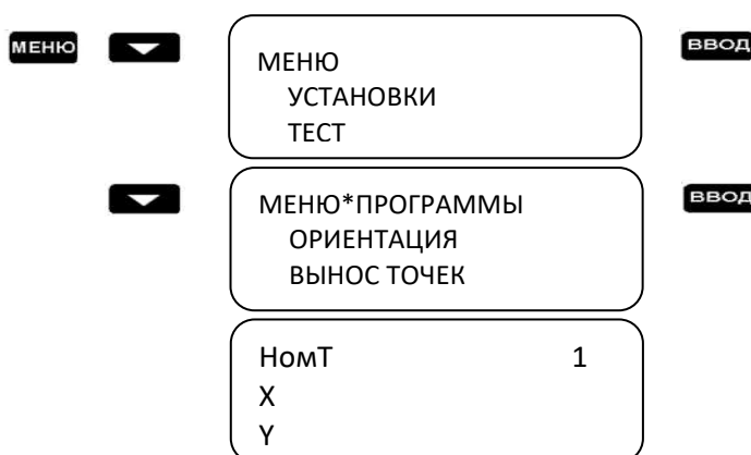
Рис. 6.7. Визначення координат невидимої точки об'єкта прямокутної форми [1]
