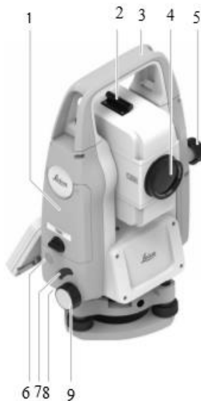
Рис. 1.1. TS03 R500 (5 "): 1 – відділення для SD-карти і USB-кабелів; 2 – оптичний візор; 3 – зйомна транспортувальна ручка із регульованим гвинтом; 4 – об'єктив з вбудованим далекоміром; 5 – навідний гвинт вертикального кола; 6 – динамік; 7 – клавіша «Тригер»; 8 – серійний порт RS232; 9 – навідний гвинт горизонтального кола [2]
