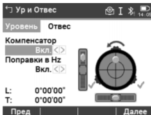
Рис. 1.5. Підказка потрібного напрямку обертання електронного рівня [2]
