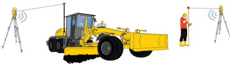
Рис. 1.1 Схема роботи технології 3D LPS [1]
